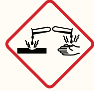
Aşındırıcı (korozyif) madde
